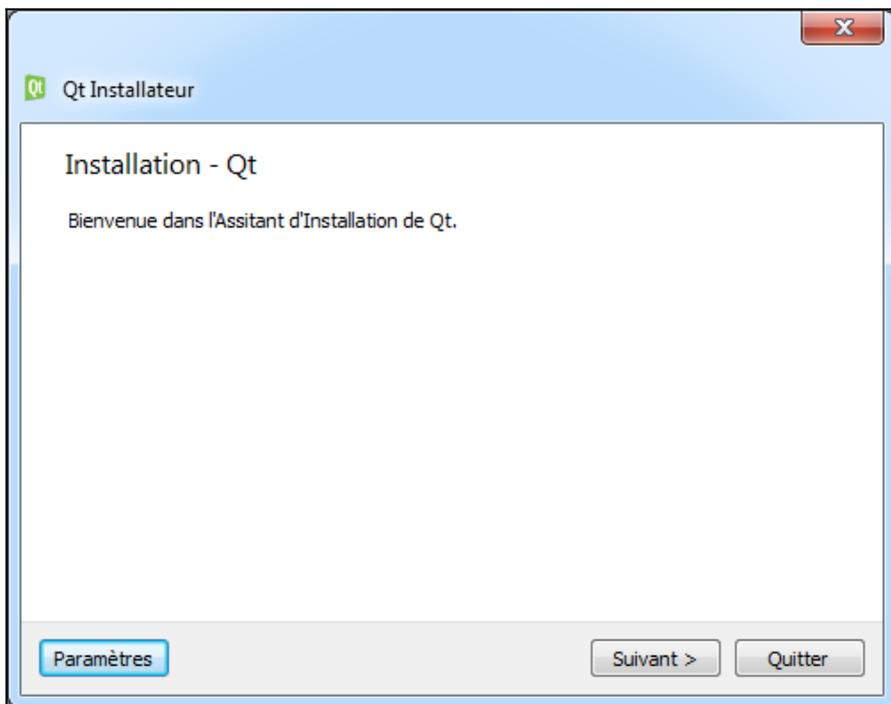
Le bouton “Paramètres” permet de configurer un serveur proxy si vous en utiliser un et d'ajouter des dépôts pour Qt.
