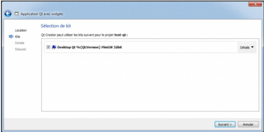
Le projet par défaut propose de créer une classe *MainWindow* (fenêtre principale). On va être gentil, on va pas le contrarier, on le laisse faire. Cliquez sur Suivant.
